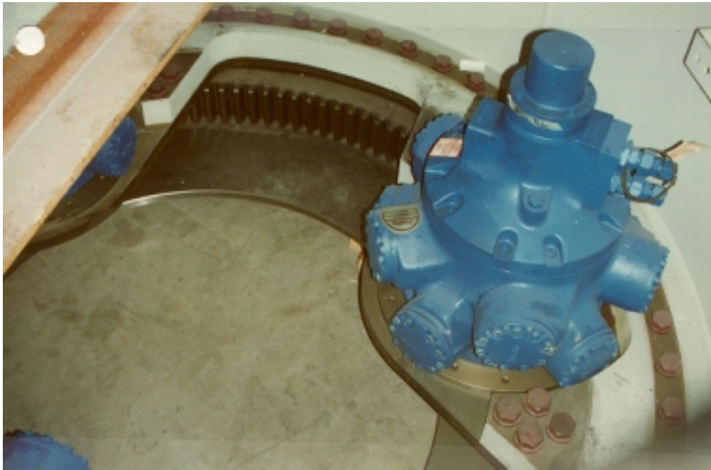
Foto 10: Kruilager van een MW windturbine en één van de drie kruimotoren. (Foto: Vrije Universiteit Brussel)
