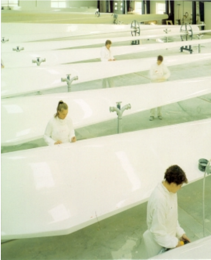
Foto 3: Productie van bladen vergt nog veel handwerk. De afwerking is o.a. van groot belang voor het aërodynamisch geluid. (Foto: VESTAS Denemarken)
