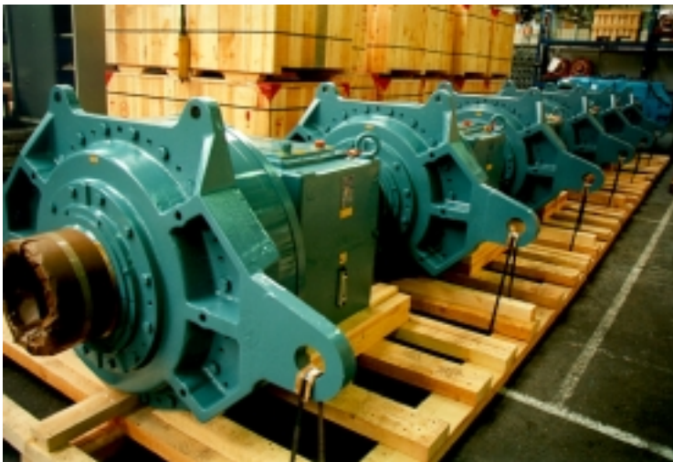
Foto 7: Tandwielkasten voor 600 kW turbines van de Vlaamse fabrikant Hansen uit Edegem staan klaar voor verzending. Hansen Transmissions is een van de belangrijkste constructeurs van tandwielkasten voor de windindustrie. (Foto: Hansen Transmission International)
