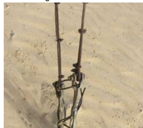
Fig. 64: Rusted guy wire
