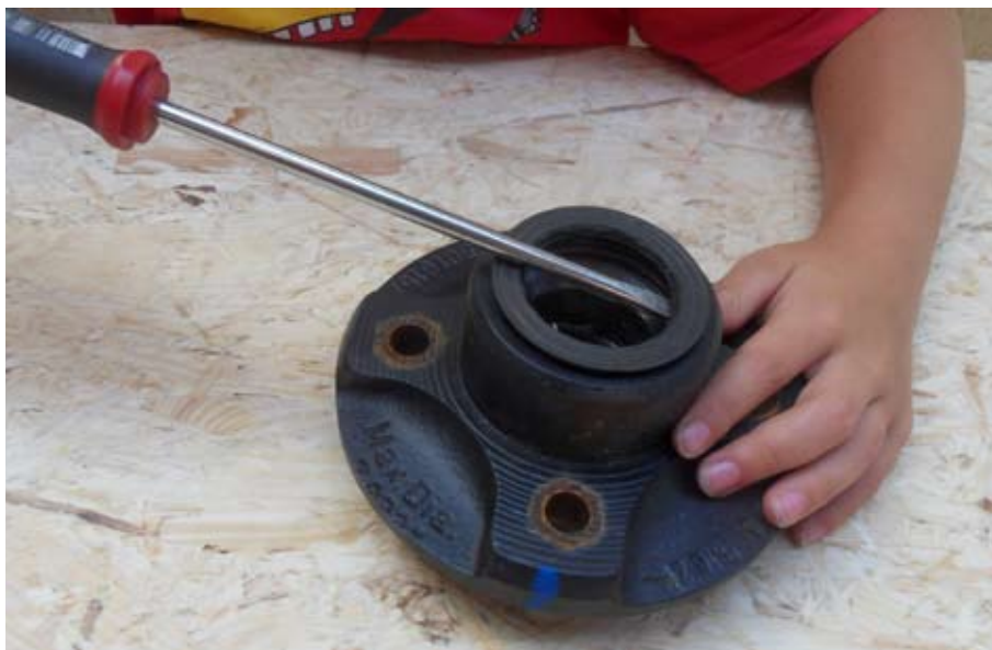
Fig. 37: Remove the seal
